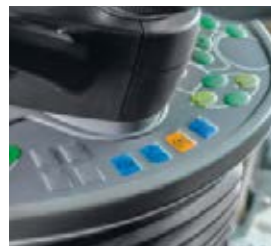
Klawiatura membranowa do aktywacji blokady elementu roboczego i funkcji tłumienia.
