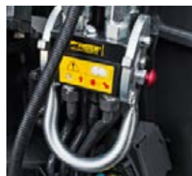
Standardowy szybkosprzęg do szybkiego montażu i demontażu.
