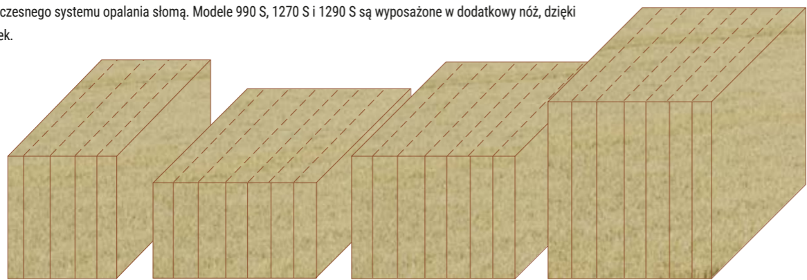
Wymiary kostek 990 (szer. x wys. x dł.) 800 x 900 x do 2740 mm
