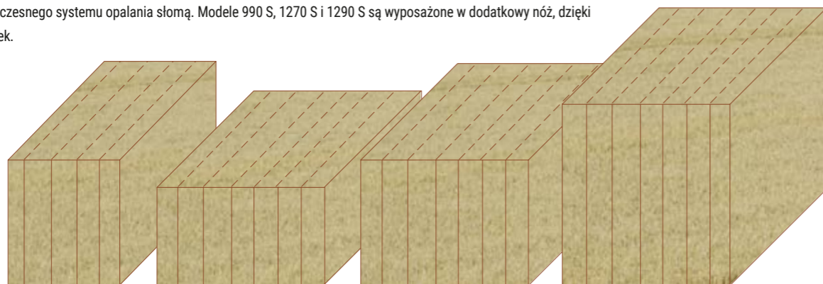
Wymiary kostek 990 (szer. x wys. x dł.) 800 x 900 x do 2740 mm Wymiary kostek 1270 (szer. x wys. x dł.) 1200 x 700 x do 2740 mm Wymiary kostek 1290 (szer. x wys. x dł.) 1200 x 900 x do 2740 mm Wymiary kostek 12130 (szer. x wys. x dł.) 1200 x 1300 x do 2740 mm
