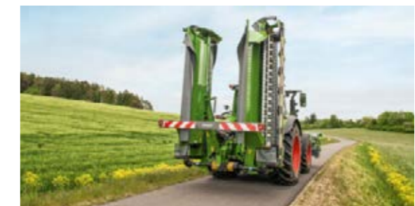
Po złożeniu wysokość kosiarki pozostaje poniżej 4 m, a dzięki niskiemu środkowi ciężkości ciągnik z podłączoną do niego maszyną łatwo się prowadzi.
