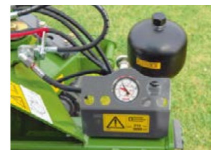
Hydrauliczno-pneumatyczne odciążanie zespołu tnącego TurboLift zapewnia pojedyncze, płynne cięcie.
