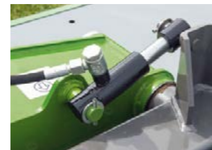
Siłownik kompensacyjny stabilizuje kosiarkę na uwrociach i drogach.
