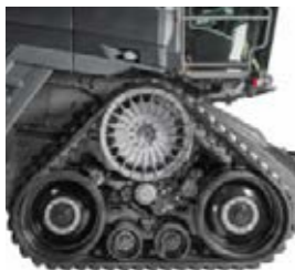
Układ gąsienic TrakRide zapewnia wyjątkowo niski nacisk na glebę.
