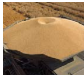
Zbiornik Streamer 210 o pojemności 17 100 l rozładowywany jest w ciągu około 81 sekund.
