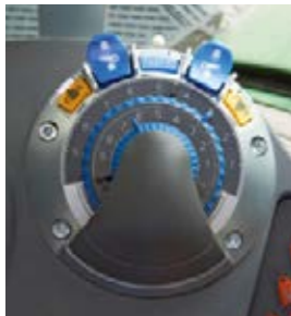
Intuicyjna obsługa z kompaktowym modulem sterowania tylnym TUZ i sterowaniem WOM.
