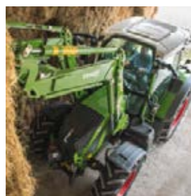
Panoramyczna szyba z 77-stopniowym polem widzenia do góry i nad nadkolami.
