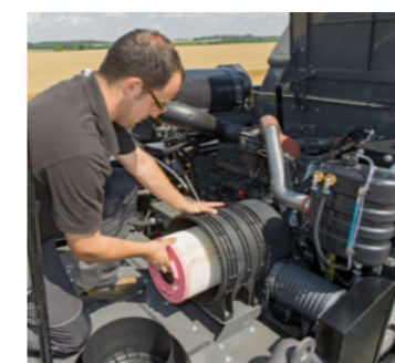
Czyszczenie filtra powietrza
