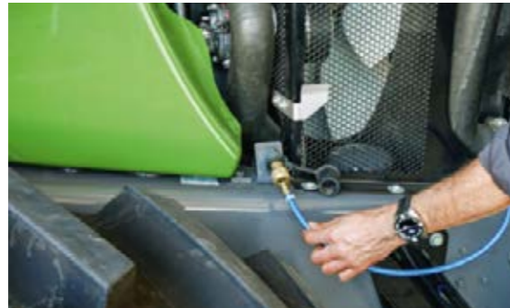
Układ sprężonego powietrza znajduje się z przodu i umożliwia czyszczenie chłodnicy.
