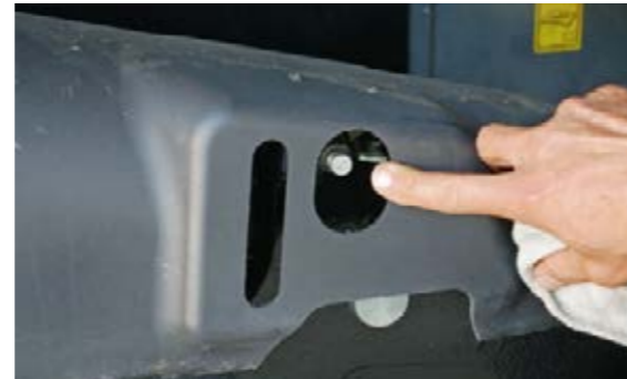
Zapewniony jest łatwy dostęp do złączy ciśnienia do napełniania gaśnicy.
