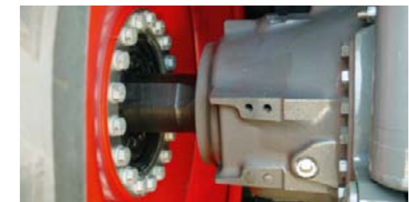
Wytrzymała konstrukcja osi tylnej zapewnia jej bardzo długą żywotność. Poziom wewnętrzny oleju można łatwo sprawdzić przez wzniki inspekcyjne.
